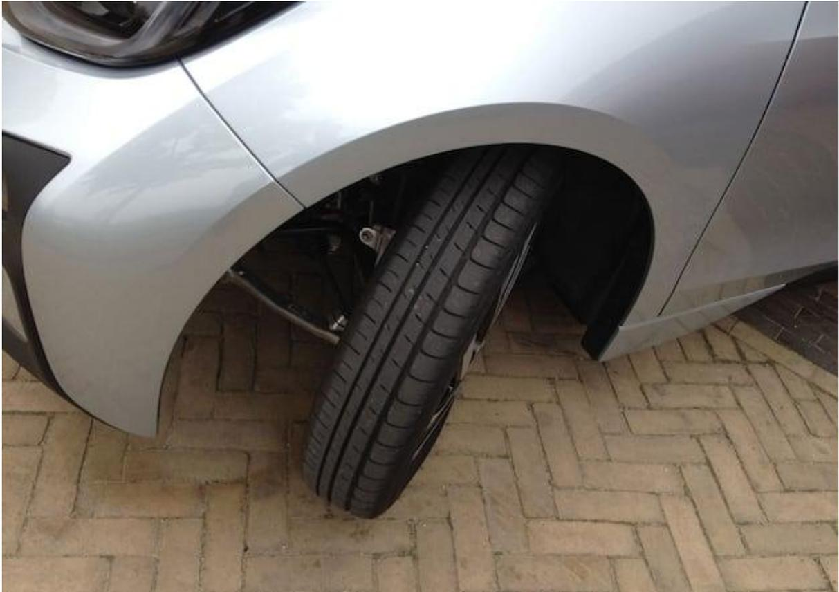
Aus dieser Perspektive fallen die schmalen Reifen des **BMW i3** ins Auge – sie bedeuten weniger Rollwiderstand
